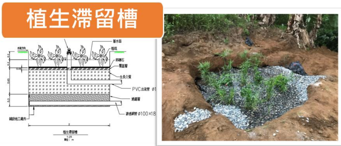
圖 2 植生滯留槽設計實例
